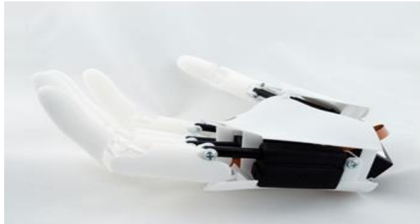
Şekil 14: Youbionic Şirketi Tarafından 3B yazıcı ile üretilen biyonik el
