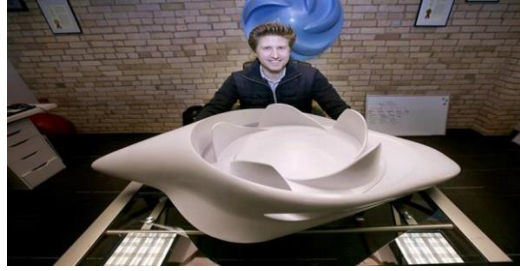
Şekil 9: 3B yazıcılar ile üretilen hidroelektrik santrali için tribün üretimi
